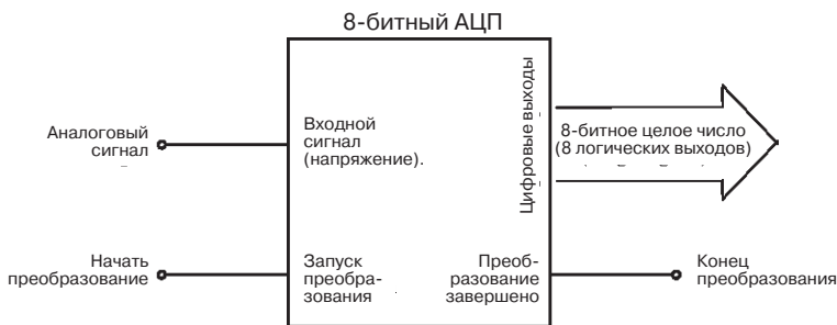
Рис. 11.1. Блок-схема 8-битного АЦП
